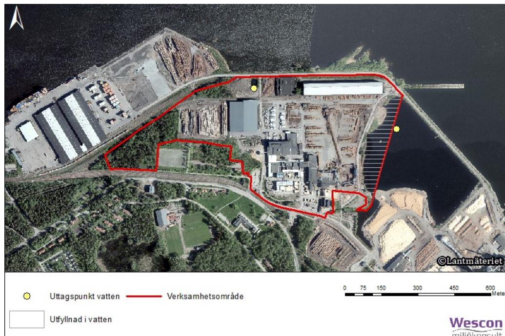
Figur 2.5, Vattenverksamhet. Utfyllnad av vik samt uttagspunkter för vatten, befintlig och alternativ
