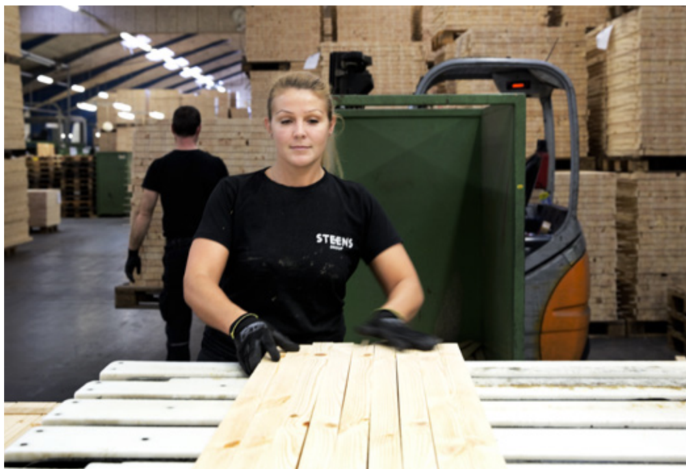
Virket från Setra klyvs i lameller som sedan sätts ihop till limfog som används i möbeltillverkningen.
