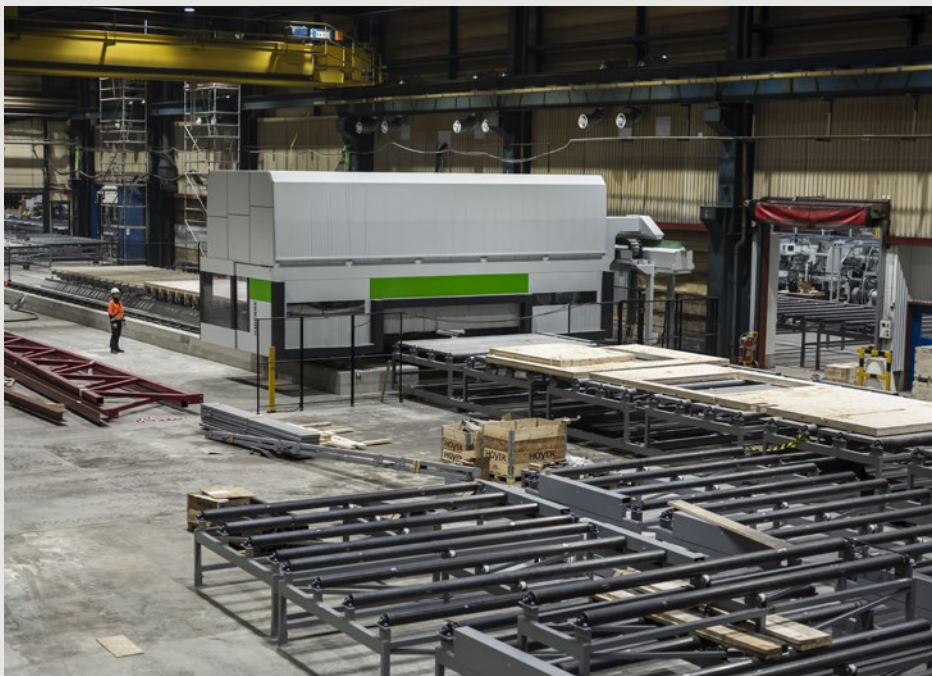
Hjärtat i fabriken är den datorstyrda CNC-maskinen som tar fram exakta byggdelar utskurna med millimeterprecision.
