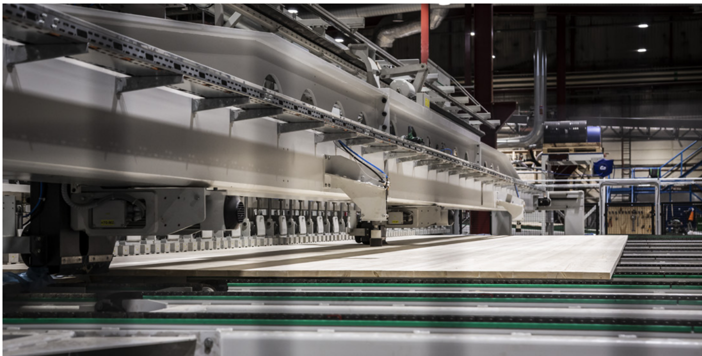
Med sitt gigantiska pressbord på 6 x 20 meter är limpressen i Långshyttan en av världens största.
