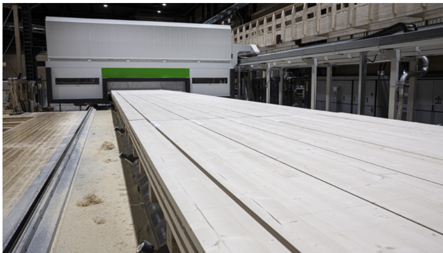
Den datorstyrda CNC-maskinen klarar allt från precisionsarbete till grövre utskärningar i KL-träskivorna.
