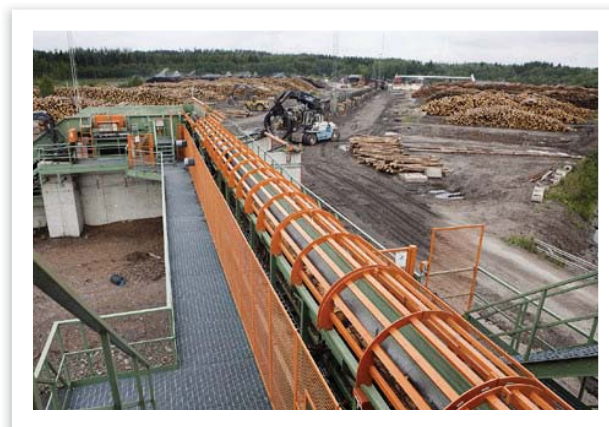
Hasselfors är ett högproducerande och flexibelt sågverk som får beröm för både kvalitet och leveranssäkerhet. På bilden ser vi intaget till reducerbandsågen.
