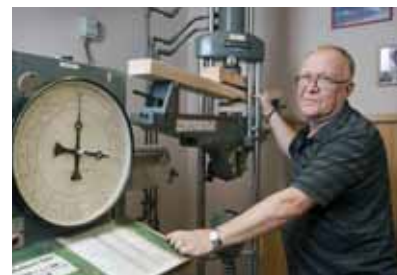
Fingerskarvarnas hållfasthet och lamellfogarnas kvalitet provas regelbundet.
