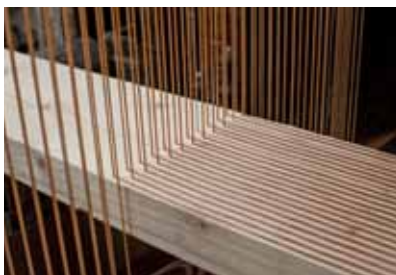
Trälamellerna passerar en ridå av lim med hög hållfasthet och beständighet.
