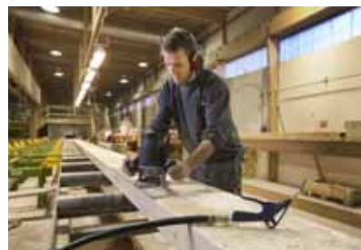
Vid avsyningen kontrolleras balken och synliga skador repareras.
