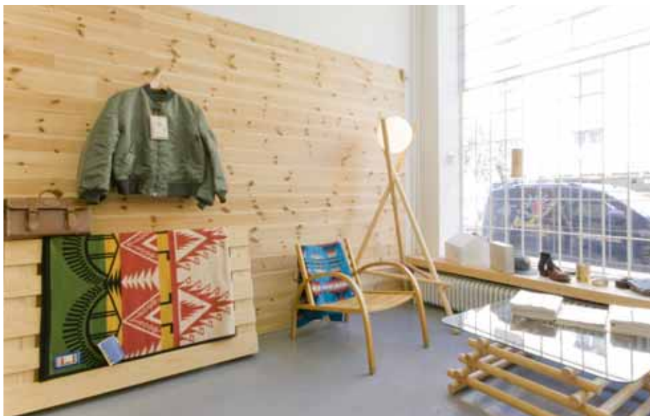
Arkitekten Daniel Franzén har skapat en fin träinredning till butiken Mr Mudd and Mr Gold på Södermalm i Stockholm. Inredningen är sparsmakad och obehandlad furu från Setra klär väggarna halvvägs till taket. Den lösa inredningen i form av provrum och montrar är handgjord i limträ och lamporna av furufaner som virats kring pappbr. Hipsterkulturen i Stockholm vallfärdar till butiken som utsetts till "Årets butik" av tidningen Café.
