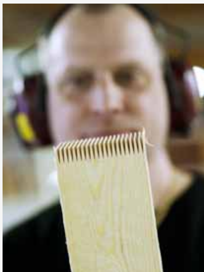
De frästa fingrarna är avgörande när det gäller att få fogen tät och stabil.
