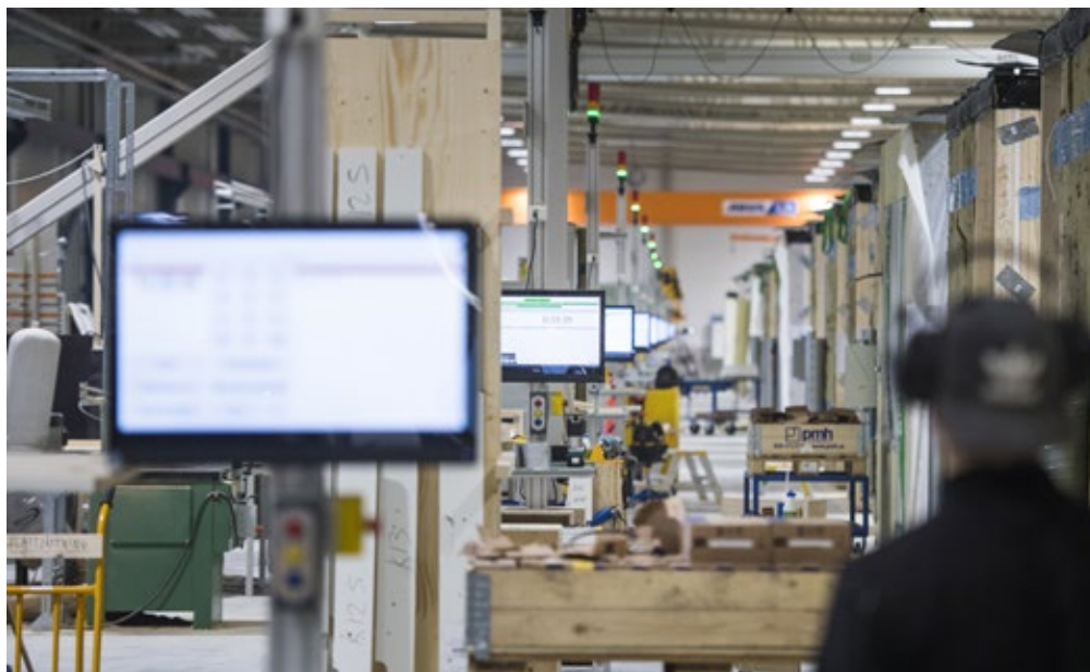
Produktionen sker på löpande band utmed stationerna längs montageinjen där operatörer sätter ihop volymerna steg för steg.
